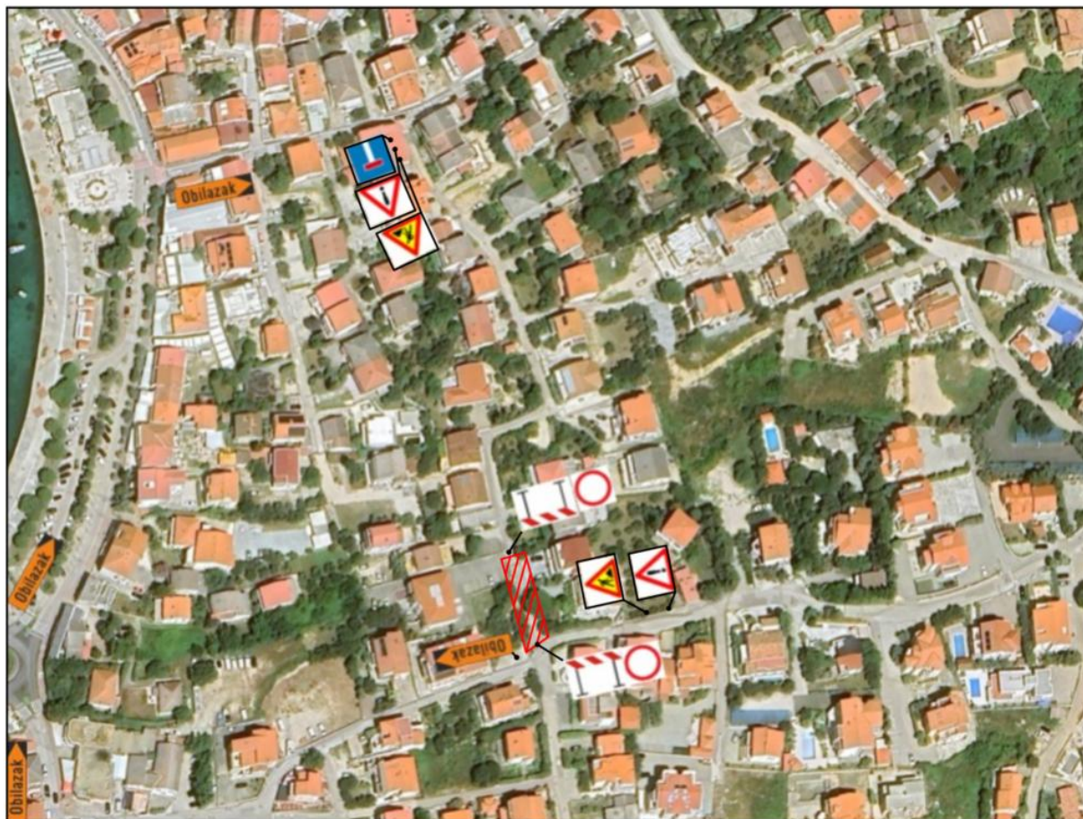
Slika 4 Regulacija prometa u zadnjoj fazi izvođenja radova
