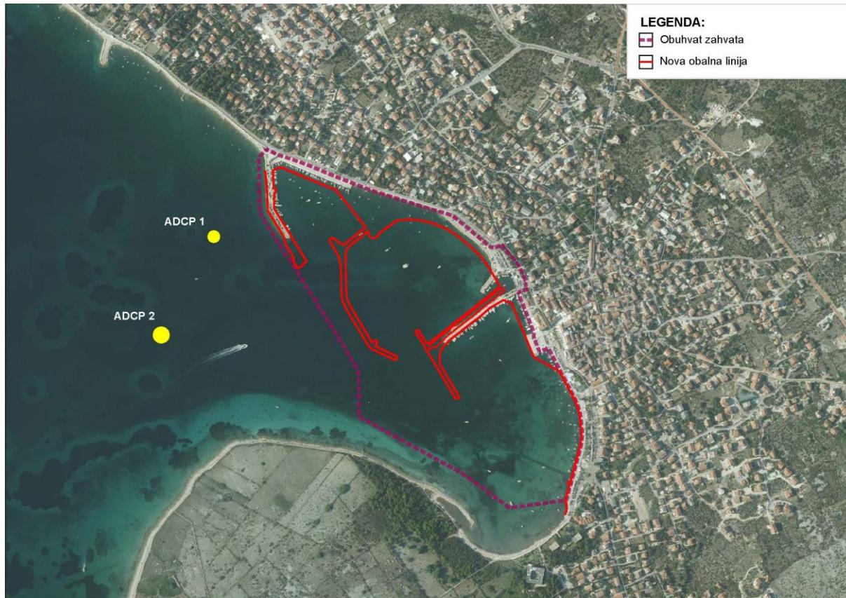
**Slika 4.16.** Obuhvat zahvata Luke Novalja s pripadnim strujomjernim postajama (ADCP1 sjeverni, ADCP2 južni)
